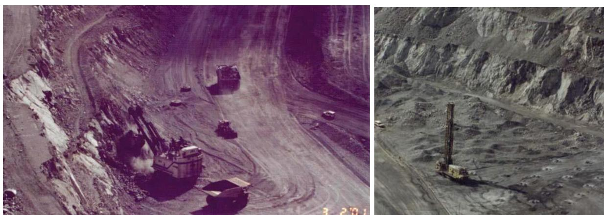
**Incoherentes:** Una pequeña cantidad de yacimientos superficiales están integrados por materiales incoherentes. Se trata de aglomerados, arenas, sales de «cosecha» y arcillas que, comúnmente requieren métodos de arranque muy sencillos, que se resuelven con el uso de excavadoras y máquinas similares, o con pico y pala, a nivel artesanal. Se incluyen las explotaciones de arena por dragado de fondos fluviales, como el que se hace en los ríos Paraná y de la Plata.
